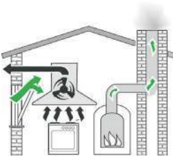
Betrieb mit Fensterkippschalter
