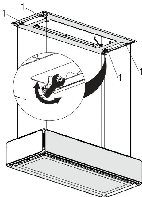
9. ➔ Für eine Feinjustierung bei einem Niveauunterschied, an dem Einstellmechanismus der Tragseile mit Hilfe eines passenden Schraubenschlüssels über Links- oder Rechtsdrehungen einstellen (Abb. 25).
