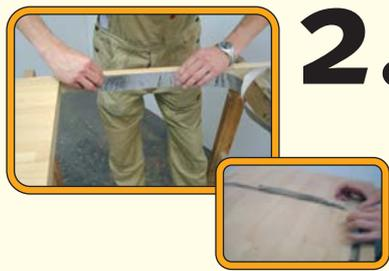
**2.** Auf die Spanplattenkante wird eine Dampfsperre mit einem entsprechenden Klebeband mit einer Dicke  $\leq 0,1$  mm aufgeklebt, z. B. Aluklebeband. Dem Inlayrahmen wird werkseitig umlaufend 0,5 mm Luft gegeben.
